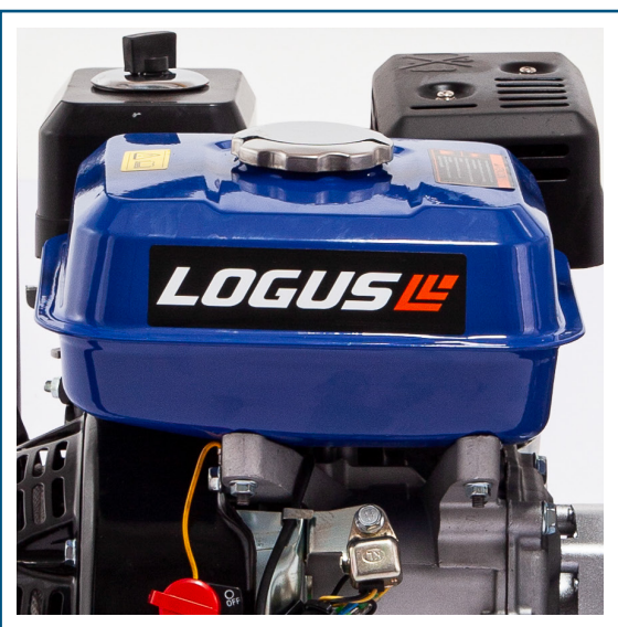
Tanque de combustible
