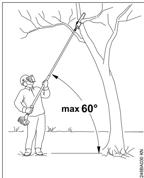
Manter o aparelho a motor inclinado, não permanecer diretamente por baixo do ramo a cortar. Não exceder o ângulo de 60° na horizontal. Presta atenção à madeira que cai para o chão.
