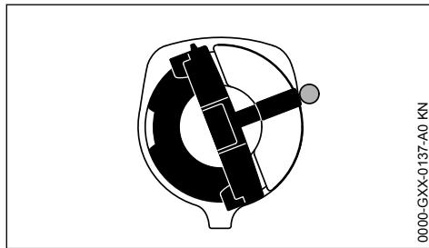
Las marcas en el cierre del depósito y en el depósito de aceite tienen que estar alineadas entre sí
