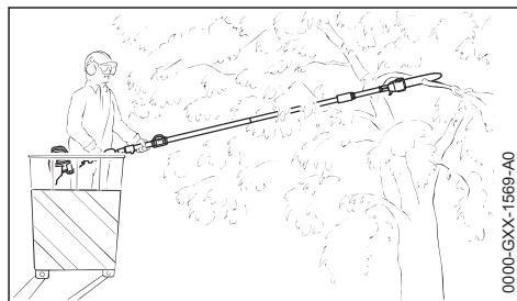
Gracias a su gran alcance, es posible cortar ramas en el propio tronco sin dañar otras ramas con la plataforma elevadora de trabajo. El ángulo de ajuste depende de la posición de la rama.
