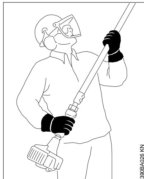
Segurar no aparelho a motor sempre **com as duas mãos** – mão direita no cabo de operação – mão esquerda na haste – mesmo para canhotos. Agarrar com firmeza o cabo de operação e a haste com os polegares.
