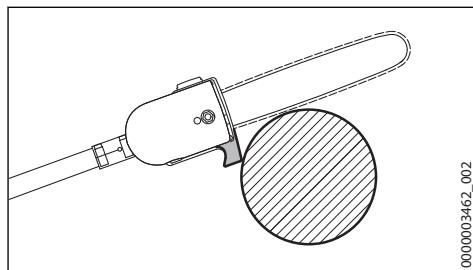
Encostar a guia na zona do gancho no ramo durante o corte de separação. Isto evita solavancos do aparelho a motor no início do corte de separação.
