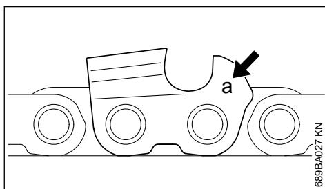
La marca (a) del paso de cadena está estampada en la zona del limitador de profundidad de cada diente de corte.
