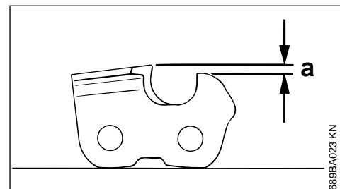
El limitador de profundidad determina el grado de penetración en la madera, y con ello, el grosor de las virutas.
