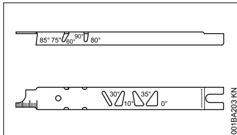
Plantilla de limado STIHL (accesorio especial, véase la tabla "Herramientas de afilar") – una herramienta universal para el control del ángulo de afilado y el de la cara de ataque, la distancia del limitador de profundidad, la longitud de diente, la profundidad de la ranura y para limpiar la ranura y los orificios de entrada de aceite.
