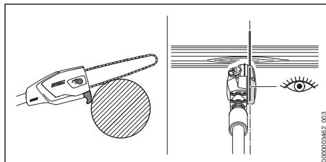
Encostar no ramo a parte da guia correspondente à zona da carcaça e efetuar o corte de separação de cima para baixo – isto evita que a corrente fique presa ao cortar. O prolongador de tubo permite posicionar a corrente com precisão.
