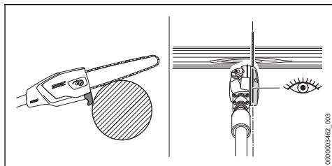
Apostrar la espada en la rama por la zona de la caja y efectuar el corte de separación de arriba hacia abajo, de esta forma se evita que la sierra quede aprisionada en el corte. Con el indicador de dirección, la cadena de aserrado se puede aplicar con precisión.
