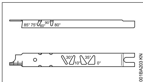
Calibrador de limas STIHL (acessório especial, vide a tabela "Ferramentas para a afiação") – uma ferramenta universal para controlar o ângulo de afiação e o ângulo de corte, a distância dos limitadores de profundidade, o comprimento dos dentes, a profundidade da ranhura e para limpar a ranhura e os furos de entrada de óleo.
