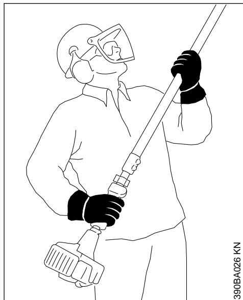
Para manejar la máquina de forma segura, **sujetarla siempre con ambas manos**; la mano derecha, en la empuñadura de mando y la izquierda, en el vástago. También al tratarse de zurdos. Asir firmemente la empuñadura de mando y el vástago con los pulgares.
