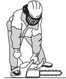
Quando el motor arranque, oirá una especie de soplido y entonces deberá **oprimir inmediatamente el estrangulador rojo**. Reponga con firmeza el cordón a su posición inicial y repita el intento hasta que el motor arranque.
