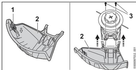
La cuchilla de acortar hilos (1) está ya montada en el protector (2) y no se permite desmontarla.
