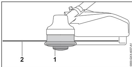
Si los hilos de corte tienen menos de 25 mm, no se pueden reajustar automáticamente.
