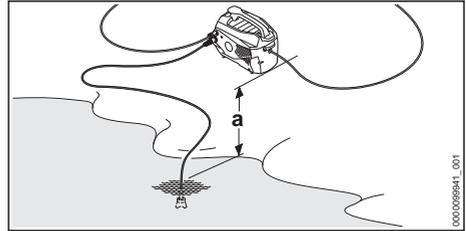
Para que se pueda aspirar el agua, la diferencia de altura entre la hidrolimpiadora de alta presión y la fuente de agua no puede superar la altura máxima de aspiración (a),
