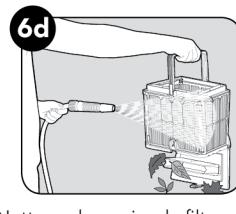
6d. Nettoyez le panier de filtrage au moyen d'un jet d'eau.
