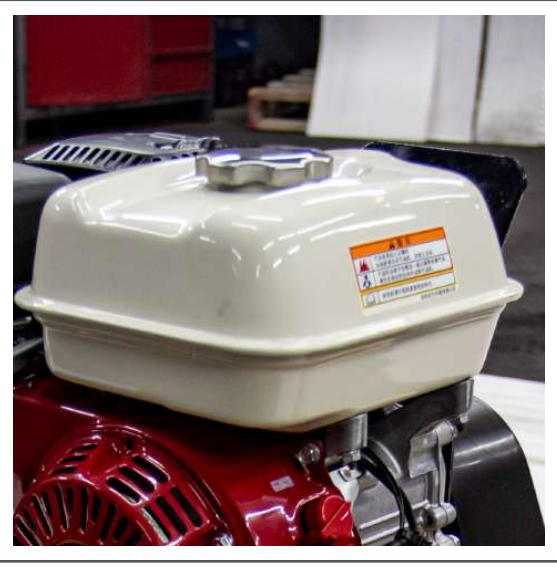
Tanque de combustible
