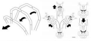
Accesibilidad: El nuevo diseño del apoya pies abierto, facilita el ascenso y descenso del operador, sin tener que pasar por encima de la plataforma.
