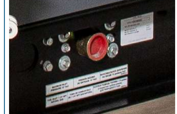
Conexión de gas
