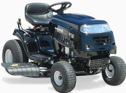
El minitractor MTD YM42547, es ideal para superficies de hasta 6000 m<sup>2</sup>. Está diseñado para propietarios que con frecuencia necesitan una máquina eficiente en grandes áreas durante todo el año. Es un tractor potente con expulsión lateral para el cuidado exigente del césped que está impulsado por un potente motor de 19.5 HP. Cuenta con una caja de 7 velocidades y reversa.
