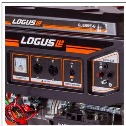
Panel de conexión y salida de 12V
