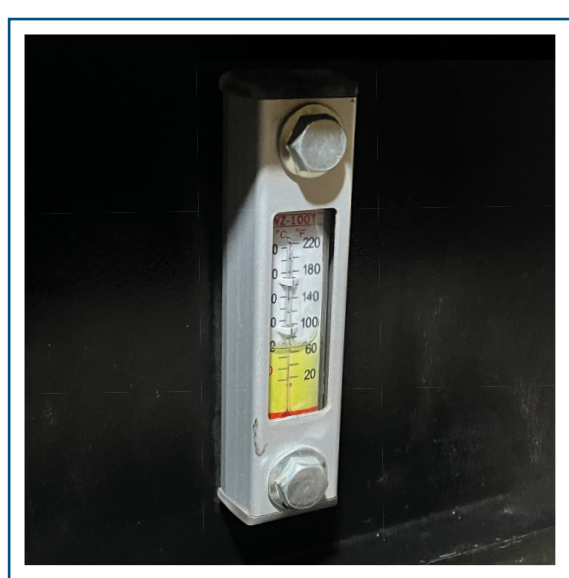
Medidor de combustible
