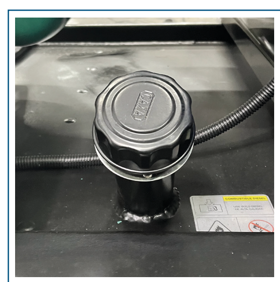
Tanque de combustible
