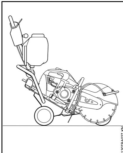
O cortador de ferro e pedra pode ser montado facilmente no carro FW 20 da STIHL (acessório especial).
