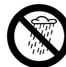
No trabajar con la máquina con lluvia ni en un entorno mojado o muy húmedo – el motor de accionamiento no está protegido contra el agua – **¡peligro de descarga eléctrica y de cortocircuito!**
