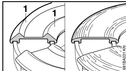
No siga trabajando con la cabeza segadoras si le faltan las piezas moldeadas (1) elevadas en la base o si las mismas están desgastadas - vea la ilustración arriba a la derecha. En este caso, la cabeza segadora puede astillarse y los objetos lanzados pueden ocasionar lesiones al operador o a las personas que se encuentren en la cercanía. Instale una cabeza segadora nueva.
