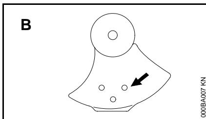
Las flechas (A) en el deflecto y el tope (B) (visto del fondo) muestran el sentido correcto de rotación del accesorio de corte. Sin embargo, al verlo de arriba, el accesorio de corte gira en sentido contrahorario.
