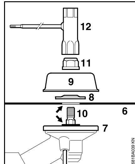
**Montaje de las herramientas de corte metálicas**
