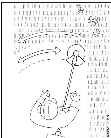
Todos los tipos de pasto y malezas se pueden cortar fácilmente con la cuchilla de cortar pasto. Para ello, la herramienta motorizada se mueve en forma de arco, como si fuera una guadaña.
