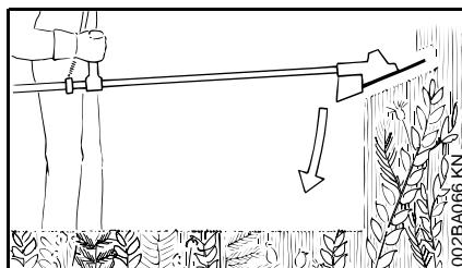
Para cortar plantas y arbustos silvestres, baje la cuchilla giratoria para matorrales hasta la planta para crear un efecto de picado, pero mantener la herramienta por debajo del nivel de la cintura en todo momento.
