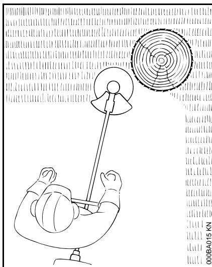
Las cabezas segadoras deben usarse solamente en las orilladoras/cortadoras de malezas con una cuchilla limitadora del hilo en el deflector para mantener el hilo al largo correcto (vea el capítulo "Piezas y controles" en el manual de instrucciones).
