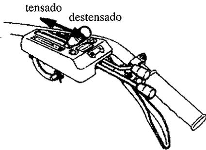
Esta palanca sirve para conectar o para desconectar la transmisión de la caja de engranajes
