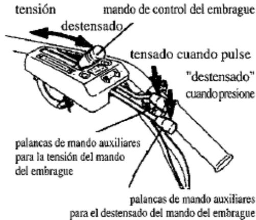
Destensado del embrague: Presione la palanca del mando auxiliar para desunir el embrague con su pulgar derecho, la palanca de mando principal del embrague debe ser puesto al estado de destensado. Tensión del embrague: Presione la palanca de mando auxiliar para unir el embrague con su pulgar derecho, la palanca de mando principal del embrague debe ser puesto en tensión.
