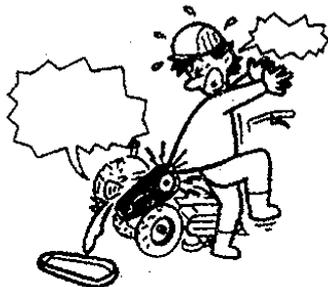
Diariamente, antes de hacer funcionar la máquina, se debe comprobar cuidadosamente si las palancas de mando del embrague y otros controles pueden moverse libremente. El ajuste debe ser hecho, así podemos asegurar el funcionamiento con seguridad y fiabilidad. Si no, pueden ocurrir averías mecánicas o accidentes.
