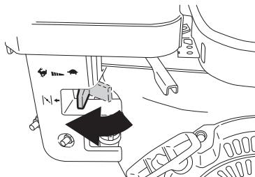
La posición de estrangulamiento cerrada enriquece la mezcla de combustible para arrancar un motor frío.
