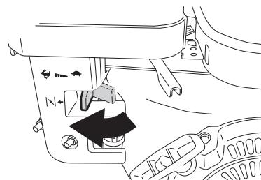
La position fermée du starter enrichit le mélange de carburant pour démarrer un moteur froid.
