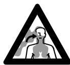
La máquina produce gases de escape tóxicos en cuanto el motor está en marcha. Estos gases puede que sean inodoros e invisibles pero pueden contener hidrocarburos y benceno sin quemar. No trabajar nunca con la máquina en locales cerrados o mal ventilados – tampoco con máquinas de catalizador.
