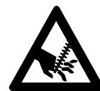
Não tocar nas lâminas de corte com o motor a funcionar. Quando as lâminas de corte são bloqueadas por um objecto, parar imediatamente o motor – é só nesta altura que o objecto é tirado – **perigo de ferir-se!**
