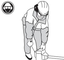
**¡NOTA!** No poner ninguna parte del cuerpo en la superficie marcada. El contacto puede causar quemaduras en la piel o sacudidas eléctricas si el excitador de ignición es defectuoso. Utilice siempre guantes protectores. No emplee nunca una máquina con un excitador de ignición defectuoso.
